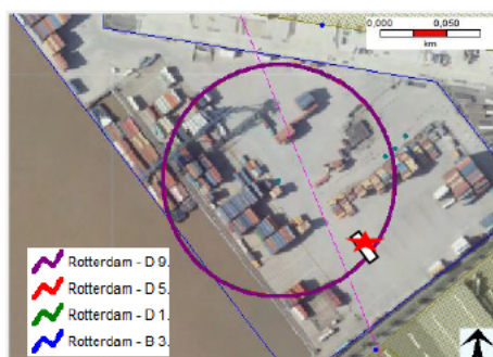
Figuur 7 Gat van 50 mm; effectzone (alle windrichtingen) warmtestraling 10 kW/m 2
