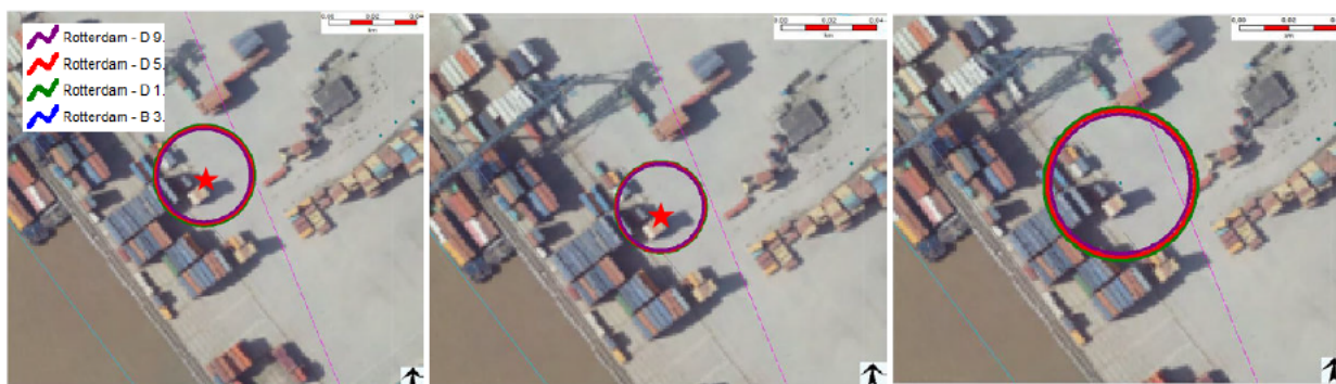
Effectgebied warmtestraling bij lek 10 mm, van links naar rechts: 10, 3, 1 kW/m 2 (duur max. 50 sec)
