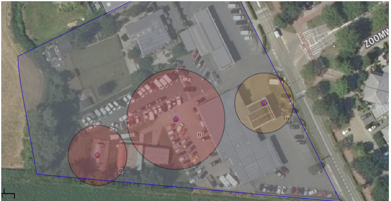
Afbeelding 1: PR 10-6/jr. contouren vulpunt, reservoir en afleverzuil Autobedrijf Bosman (bron: RRGs)
