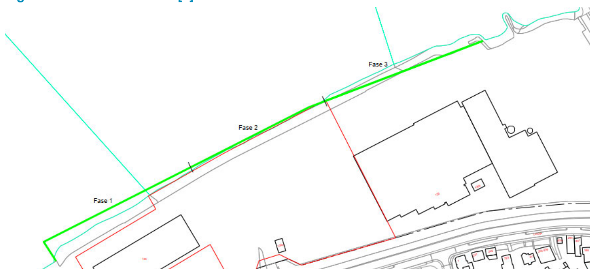
Figuur 4. Locatie damwand [8]
